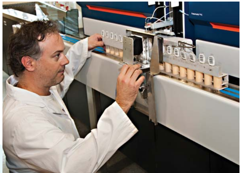
Analyseur à infra-rouge qui analyse des échantillons de contrôle laitier.
